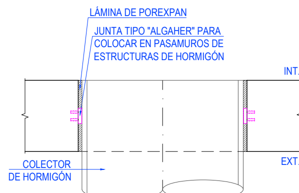
DETALLE DE JUNTA EN COLECTORES DE HORMIGÓN
